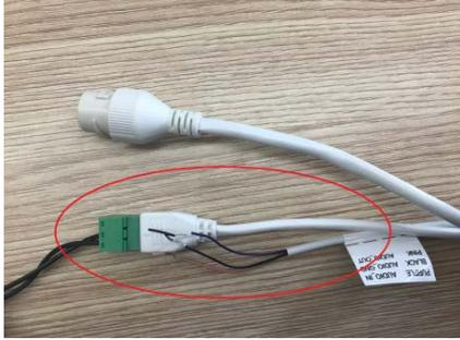
(2) 使用绝缘胶带对连接线缆做好绝缘防护。
