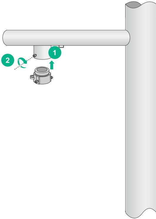
球机安装至转接环的方式与壁装支架安装方式相同，安装步骤请参见[2.5.1 2. 安装球机](#)。支架定制时需要考虑到尾线防水问题，线缆可藏于支架管道内部或单独藏线盒中，具体操作可参见[4.1.1 摄像机防水](#)。
