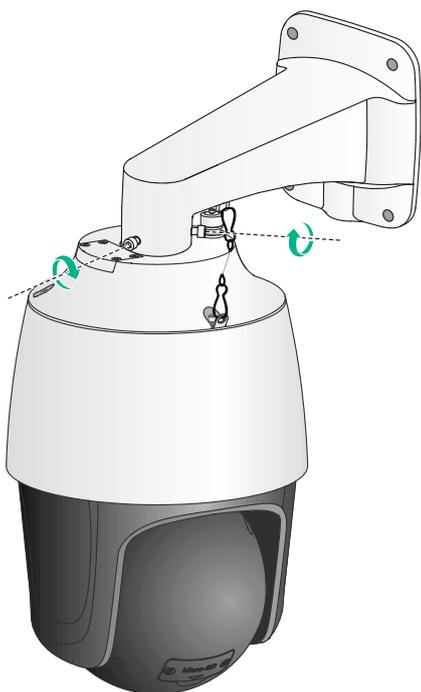
(4) 固定完毕后撕掉镜头前的红外灯保护膜。
